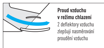
Ideální výstup proudu vzduchu v režimu chlazení
