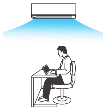
Ideální výstup proudy vzduchu v režimu chlazení
